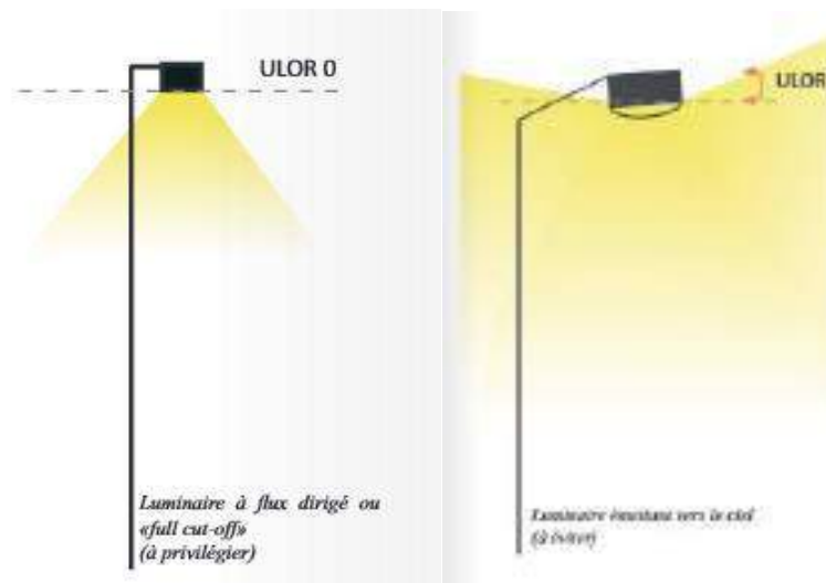
SCHEMA EXPLICATIF DE L'ORIENTATION DES CANDELABRES POUR EVITER LA DIFFUSION DE LA LUMIERE
